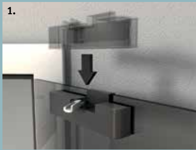
Einfache Montage: 1.) vetroMatic wird auf die Tür aufgeschoben 2.) An der Zarge ist lediglich ein kleiner Zapfen zu verschrauben
